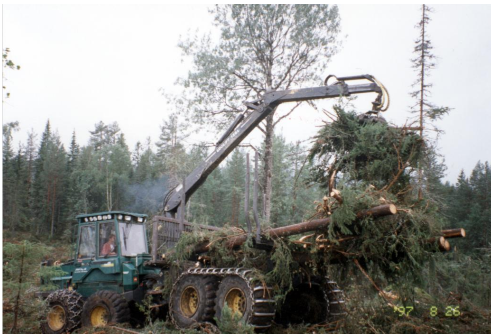
Figur 3. Anpassning till skotning av trädrester gjordes genom att förlänga lastbärarna med hjälp av fyra långa stockar och att byta till en öppen tånggrip.
