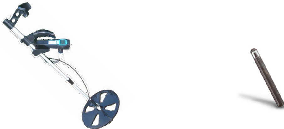
Figur 1. Den först utvecklade externa antennen med en monterad handläsare (vänster sida). Den tagg av glasampulltyp (4 x 34 mm) som användes i projektet (höger sida).
