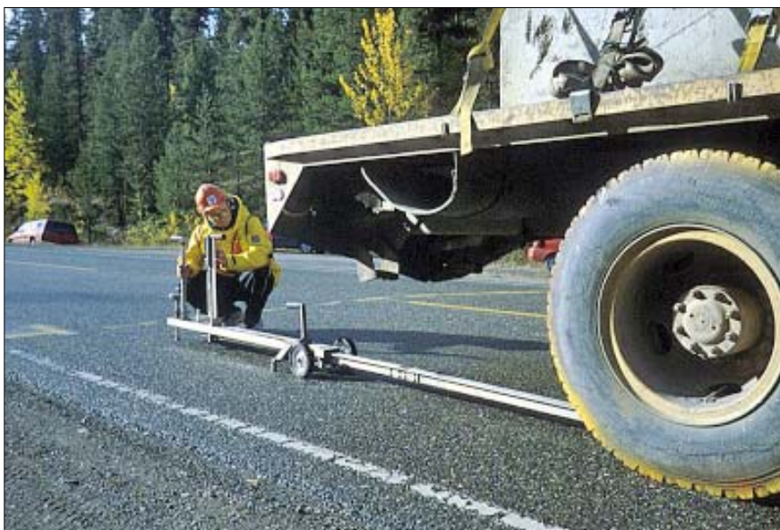
Figur 14. Mätning med Benkelman Beam.
