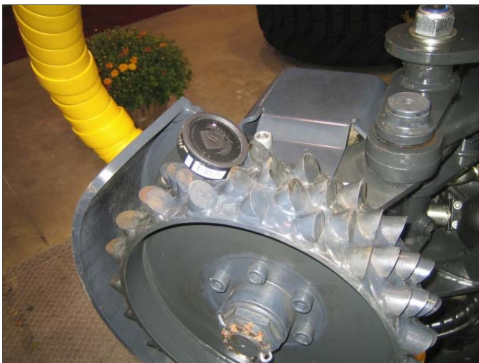
Figur 4. Ponsseaggregat med aggressivt matarhjul.
