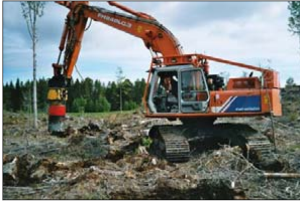
Figur 2. Stubbfräsen fungerar ungefär som en jättelik hålsåg som fräser av rotbenen och därefter lyfter stubben.
