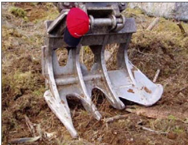
Figur 3. Stubbgrep av finsk modell. den längre tanden används för att bryta upp stubben och den breda för att markbereda. kepsen hänger på en "tumme" som används för att spräcka grövre stubbar innan brytningsförsöket.
