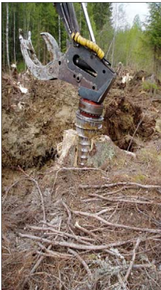
Figur 5. Stubbskruven spräcker stubben. Därefter lyfts delarna upp med gripklon som även kan användas för att dela mindre bitar.
