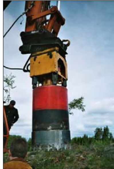
Figur 2. Stubbfräsen fungerar ungefär som en jättelik hålsåg som fräser av rotbenen och därefter lyfter stubben.
