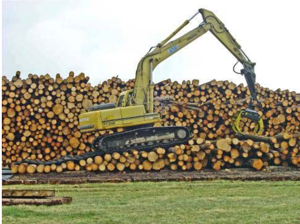
Figur 2. Medelstor terminal med särskild lastmaskin som kan lyfta virket till 7–9 m höjd. Foto: Johan Adolfsson, VMF Syd.
