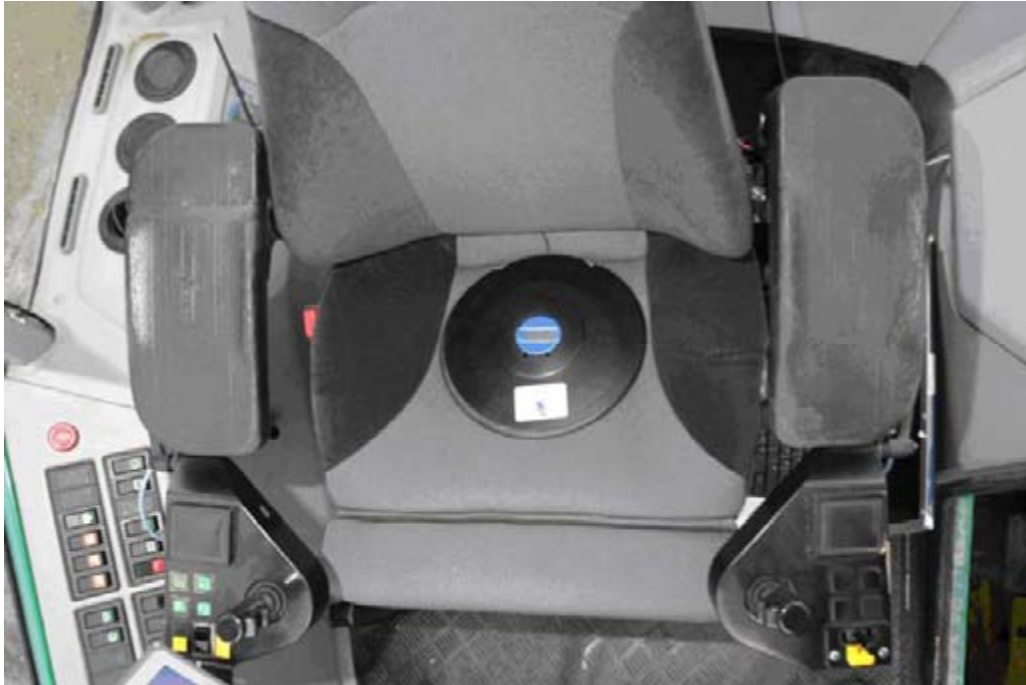
Figur 4. Instrumentet Healthvib monterad i sittplattan placerad på stoldynan.
