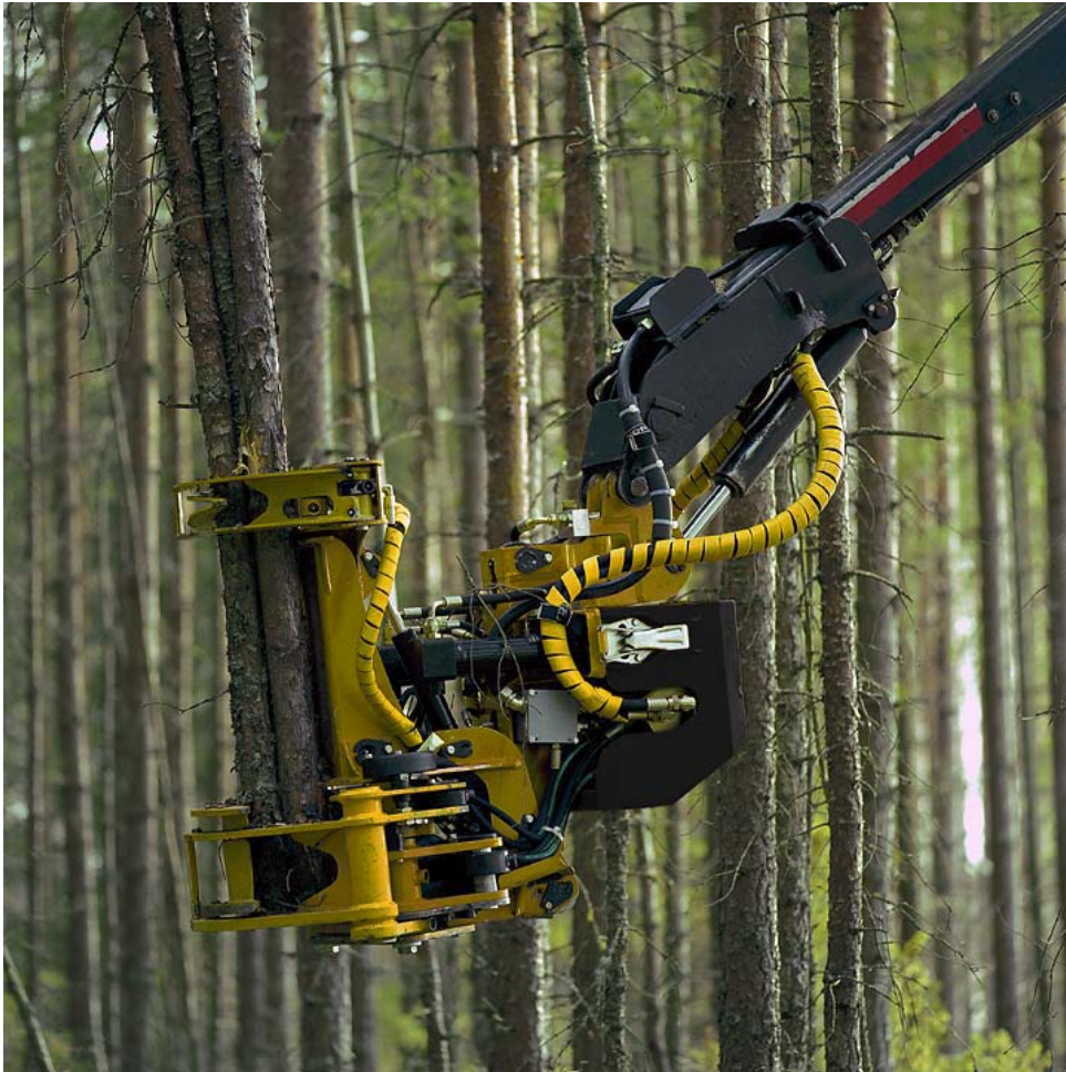
Figur 4. Ackumulerande fälldon för klena stammar.
