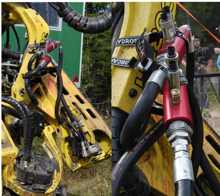
Figur 4. Vänster bild: Givare monterad för mätning av hydrauloljans tryck, flöde och temperatur före respektive efter sågmotorn. Höger bild: Närbild på givare.
