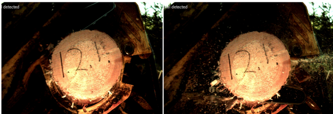
Figur 2. Bilder från höghastighetskameran. I vänstra bilden har svärdet just gått in i barken. I den högra bilden har genomkapning just skett.
