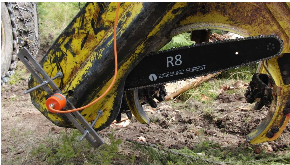
Figur 3. Pulsgivaren monterad för mätning av sågmotorns varvtal.
