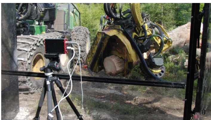
Figur 5. Bild på den tredelade skärmlösning från JPS Teknik som användes under de detaljerade mätningarna. Skärmen har två yttersidor av plåt och en midsida av säkerhetsklassat glasmaterial. Filmningen som gjordes för mätning av kaptid skedde genom glaspartiet.
