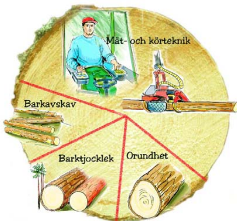
Figur 4. Orsaker till tillfälliga fel vid diametermätning i skördaren. (Möller & Sondell, 2000).
