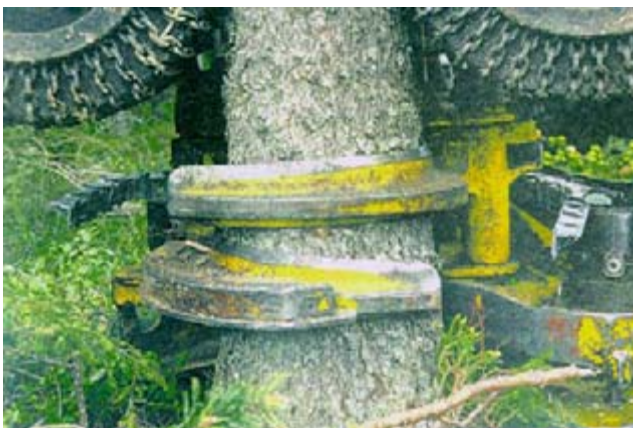
Figur 3. De flesta diametermätningssystem på skördare bygger på berörande mätning där diametern räknas ut genom mätning av kvistknivarnas läge (Bild: Skogforsk).
