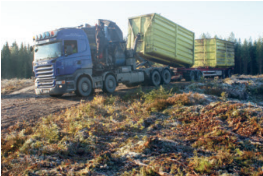
Huggbilen i studien var byggd på en Scania R560 8 × 4 utrustad med Bruks 805CT flishugg, Epsilon z90 plus kran med 9,6 m räckvidd och Palfinger lastväxlare. Ekipaget kan transportera en 35 m 3 container på lastbilen och två 40 m 3 containrar på det fyraxliga släpet. Under studien arbetade huggbilen enbart som flishugg.
