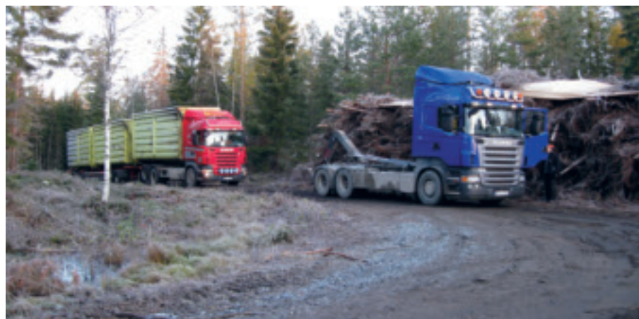
En tom containerbil anländer till avlägget samtidigt som en annan väntar på att lasta en full container på bilen.
