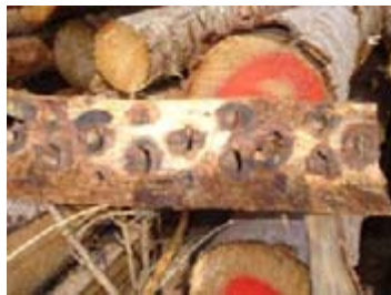
Figur 11. Barkprov påverkat av matarvalsens tänder med angrepp av granbarkborre och sextandad barkborre.
