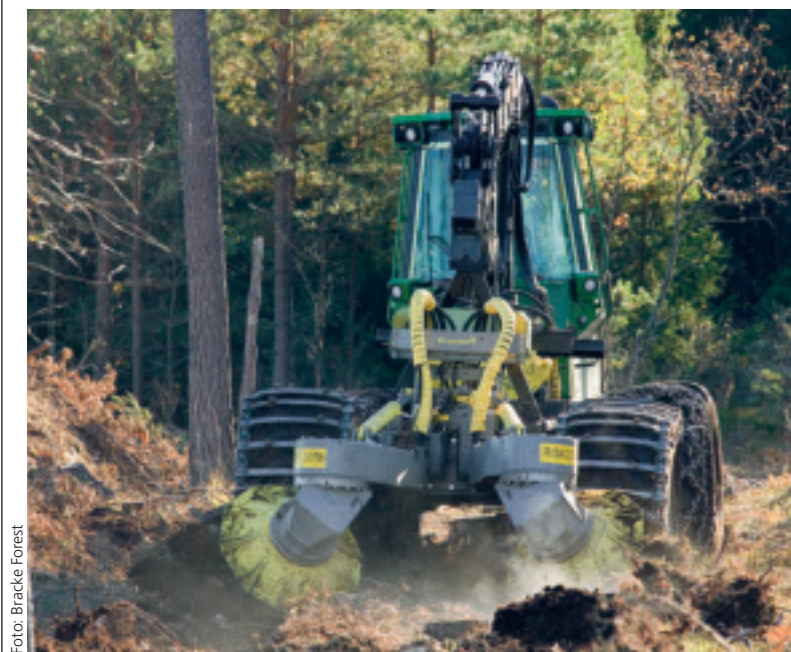
Figur 22. Harvning är en vanlig markberedningsmetod. Tallrikarna snurrar och skapar fårar och tiltor.
