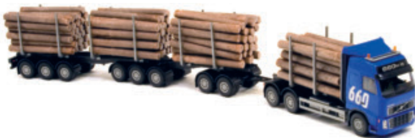
ETT-fordonet är 30 m långt och har en bruttovikt på 90 ton. Vikten fördelas på 11 axlar.
