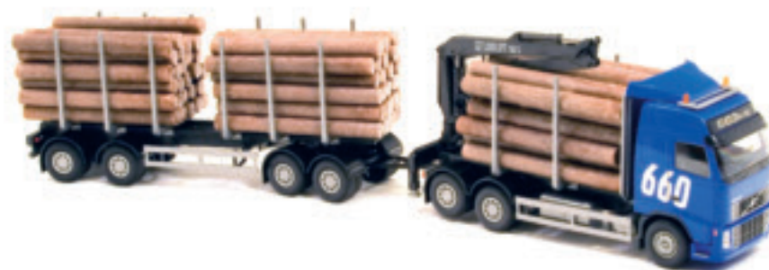
Dagens virkestransporter i Sverige. Lastbil med släp. Maximal längd 24 meter och maximal bruttovikt 60 ton. Det här fordonet klarar tre virkestravar.
