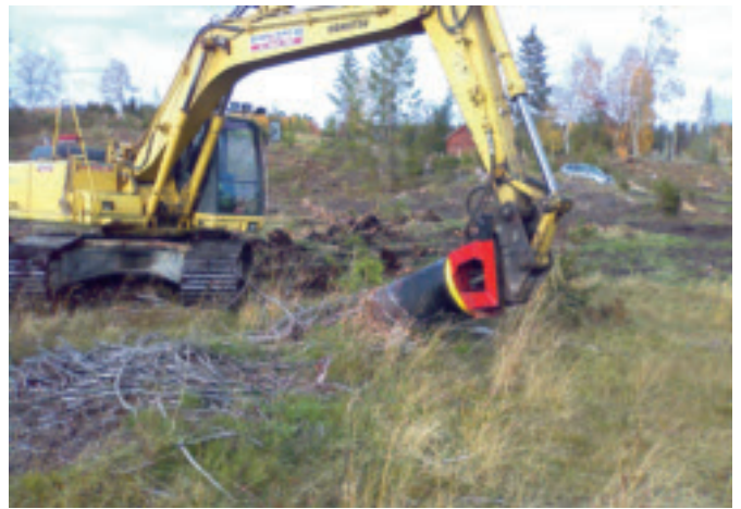
Stubbfräsen var vid studien monterad på en 20 tons Komatsu PC 210 LC. Basmaskinen var inte speciellt anpassad för arbete i skog. Kranens räckvidd var 17 meter.
