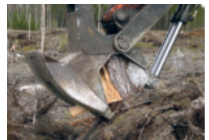
Pallari stubbrytare, ett vanligt aggregat i dag.
