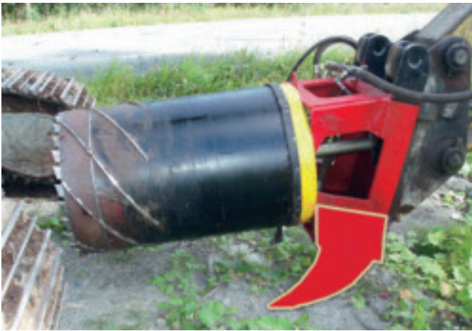
För att slippa bryta med själva trumman, utrustades Stubbfräsen efter studien med en kraftig rivtand (se montage i bilden).
