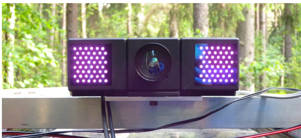
Figur 2. Sensorn Camcube från PMDTec monterad på biltak.
