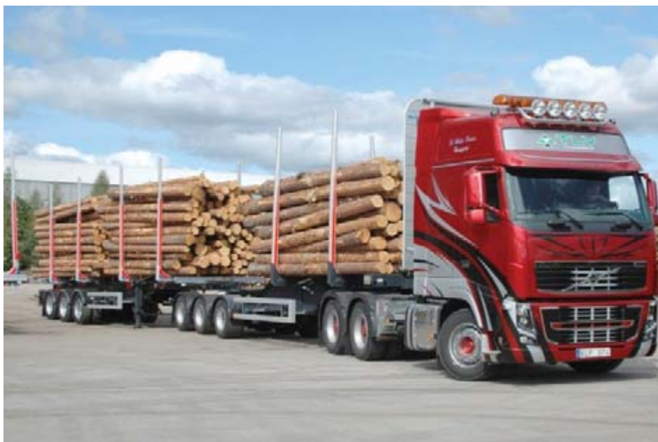
Figur 9. ST-dragbil består av en 3-axlad dragbil, följd av en 3-axlad link och en 3-axlad trailer.
