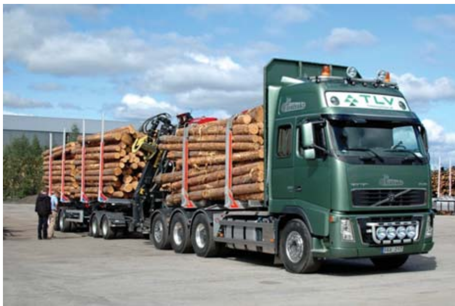
Figur 8. ST-kranbil består av en 4-axlad bil med drivning på 3 axlar, följt av en 2-axlad dolly och en 3-axlad trailer.
