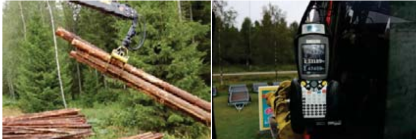
Figur 12. Intermercato's kranvåg är monterad mellan rotator och kranspets. Instrumentet för avläsning av vikten är placerad i kranhytten.
