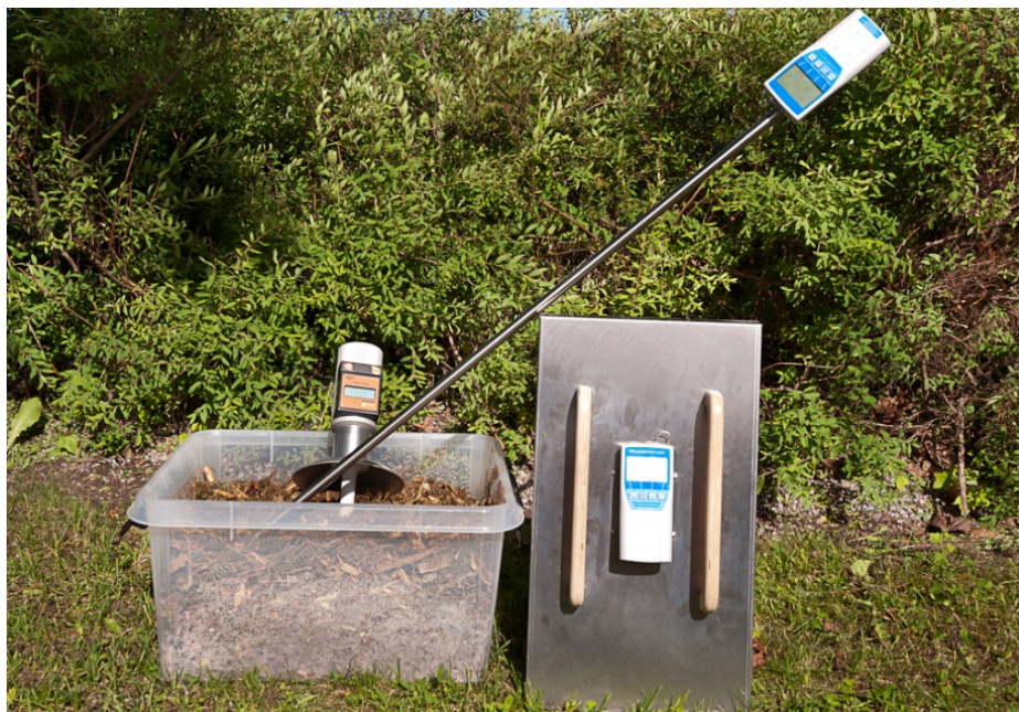
Figur 1. De utvärderade mätarna, WILE (till vänster) med tallrikssond, BLL (överst) med 1 m sond och BM2 (till höger) med rostfri mätbehållare. Plastbehållaren med flis är på 30 liter.
