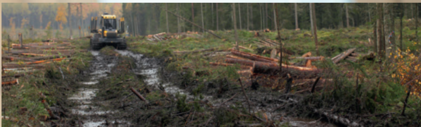
Vattensjukt. Dålig planering ger bland annat sämre framkomlighet och markskador.
