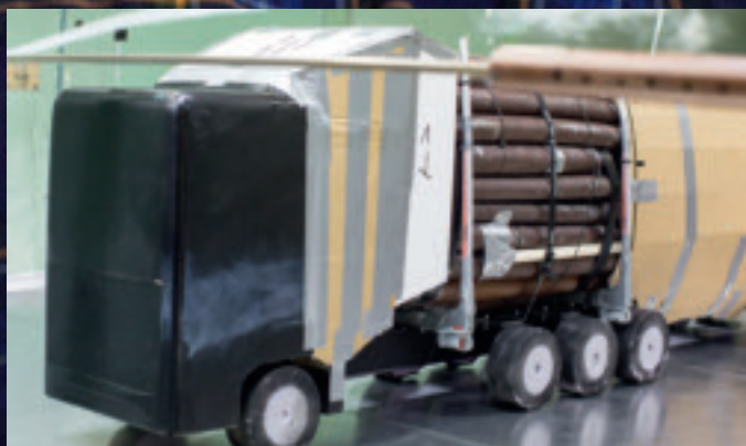
En prototyp för framtiden. Med denna utstyrsel minskar bränsleförbrukningen med 7–8 procent.
