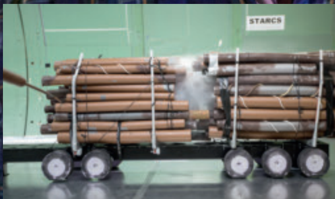
Vinden strömmar genom timmerlasset och bildar bromsande virvlar. Bilmodellen står på en våg i tunneln, där vindmotståndet mäts.
