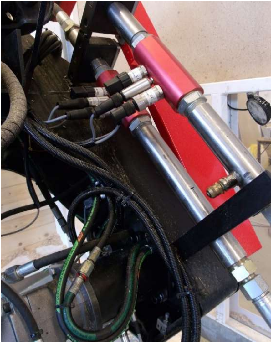
Figur 11. Givare monterade för mätning av hydrauloljans tryck, flöde och temperatur före respektive efter sågmotorn.
