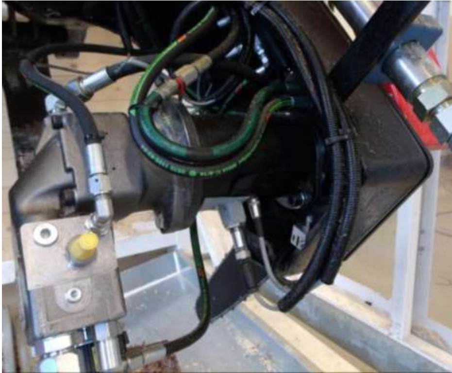
Figur 10. Bild som visar hur sågmotorns utgående axel förlängts. På den nedre delen av förlängningen syns uttagen för vridmomentgivaren (till höger) och varvtalsgivaren (till vänster).
