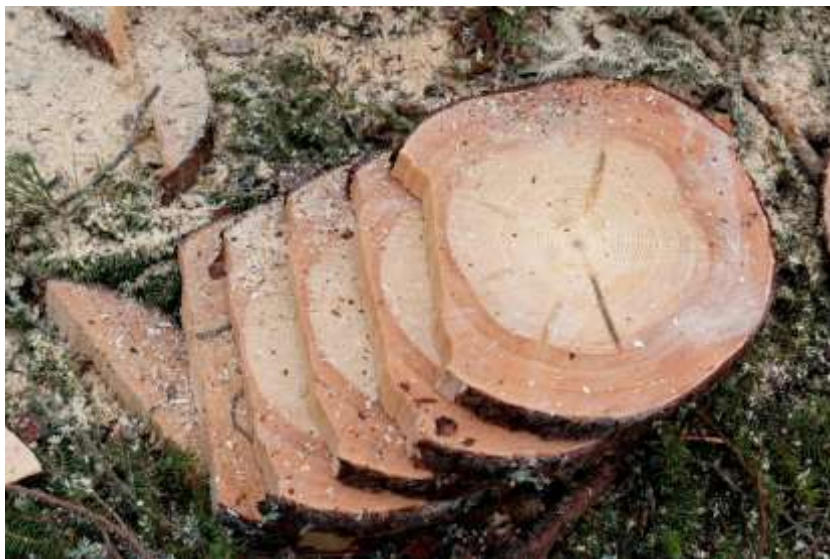
Figur 3. Illustration av trissmetoden. Trissor är kapade ur samma stockände och genom att summera trissornas tjocklek kan kapsprickans längd uppskattas.
