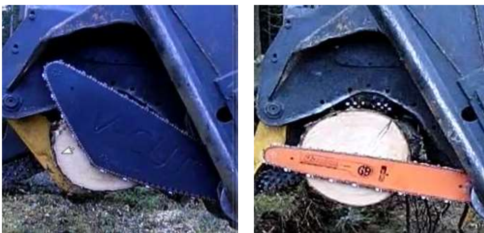
Figur 1. Illustration av sågmönstret under kapförloppet vid kapning med V-Cut (vänstra bilden) samt kapning med konventionellt svärd (högra bilden).
