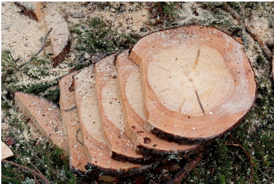
Figur 2. Illustration av trissmetoden. Trissorna är kapade ur samma stockände och genom att summera trissornas tjocklek kan kapsprickans längd uppskattas.
