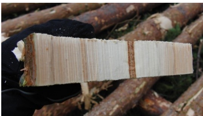
Figur 1. Kapspricka, ovan, och märgspricka, nedan. En kapspricka karakteriseras av att fibreerna slitits av, medan märgsprickan på ett tydligare sätt följer årsringarna.
