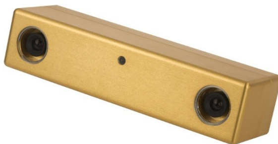
Figur 12. Bumblebee2 från Point Grey. (Bild från Point Greys webbsida, www.ptgrey.com ).
