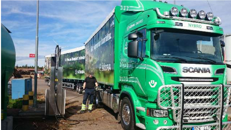
Figur 3. Södra åkeriets fordon. Tankning av RME.
