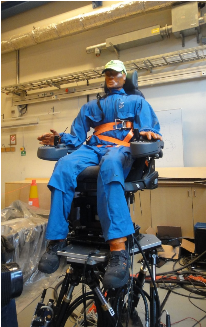
Figur 2. Stol med en testdocka på rörelseplattformen.
