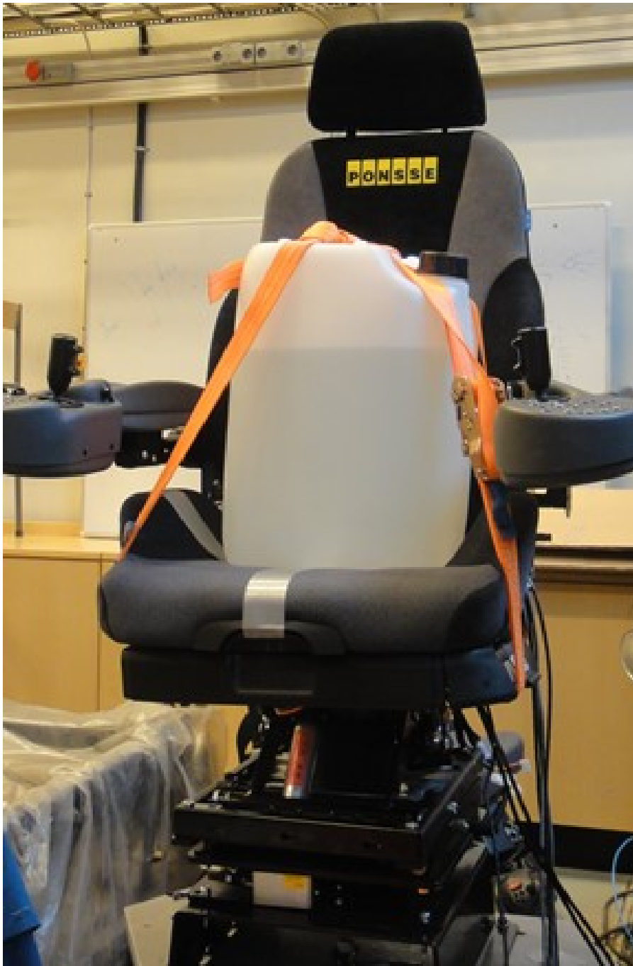
Figur 3. Stol med vattendunk på rörelseplattformen.
