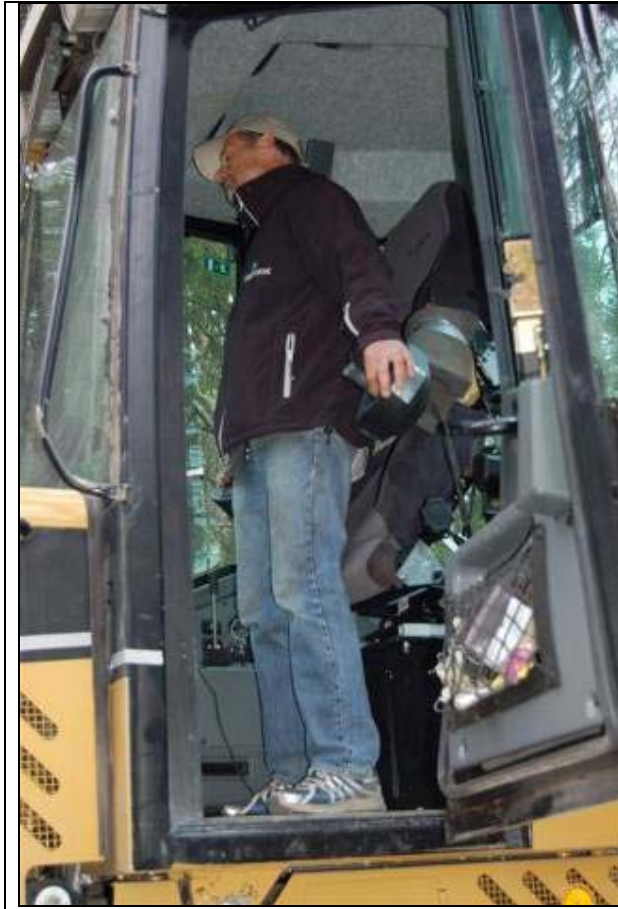
Figur 7. Genom att fortfarande ha armstöd och kontrollspakarna integrerade i stolen kan alla arbetsmoment utföras stående. Armstöden kan även användas som stöd vid terrängkörning då föraren kommer att behöva parera de gungningar maskinen utsätts för.
