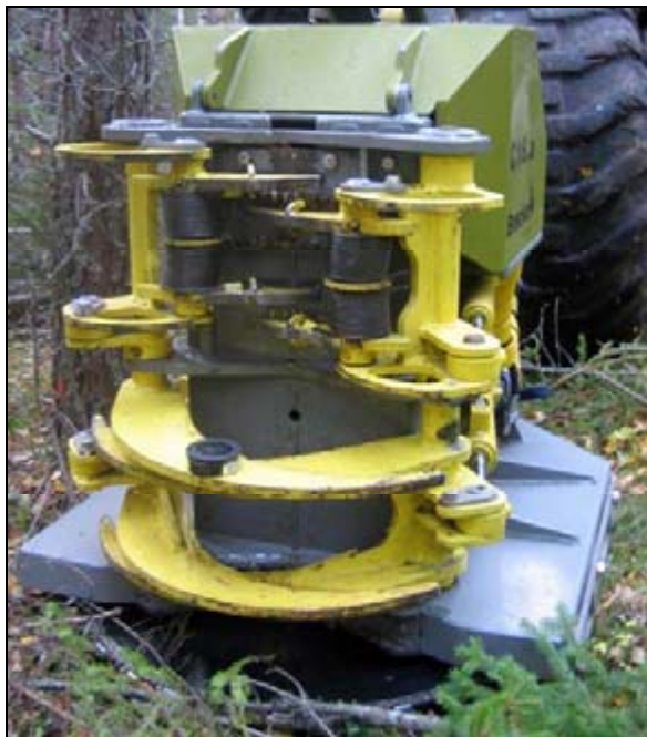
Figur 1. Bracke C16.a, ackumulerande aggregat med sågklinga.
