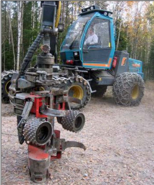
Figur 3. Log Max 4000B med ackumulerande tilläggsutrustning, monterat på en Profi-skördare, så som det kördes i försöket.
