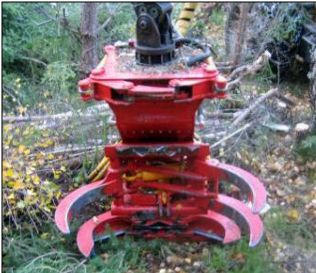
Figur 2. Naarva Gripen 1500–50E. Entreprenören har gjort vissa modifieringar av aggregatet.
