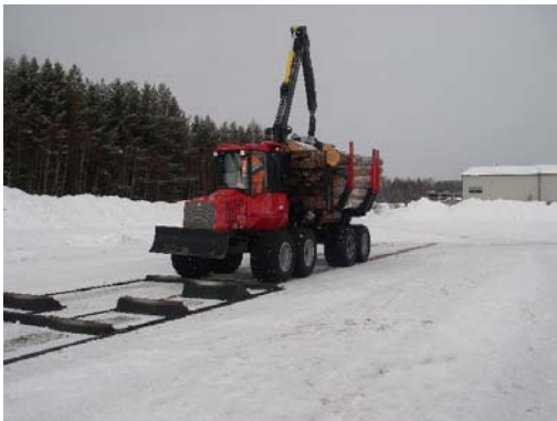
Figur 11. Verklig Valmet 860 under fältmätning med Hultins bana samt under vägning.
