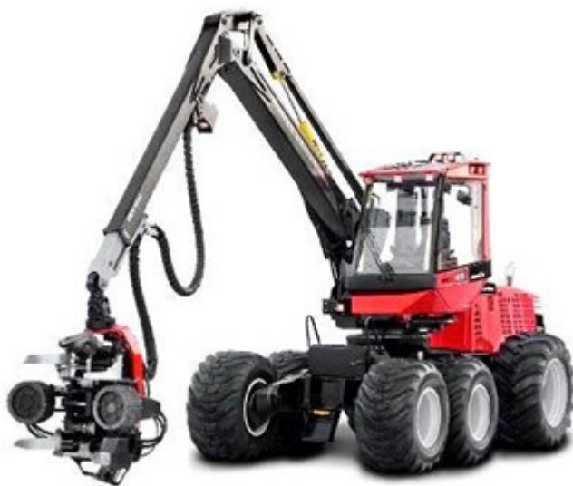
Figur 4. Illustration av Komatus placering av kran jämsides med förarhytt.
