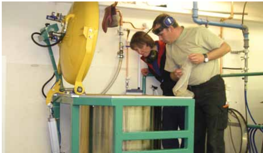
Vakuumbekant för Prevac-behandling. Foto. Ulfstend Wennström
