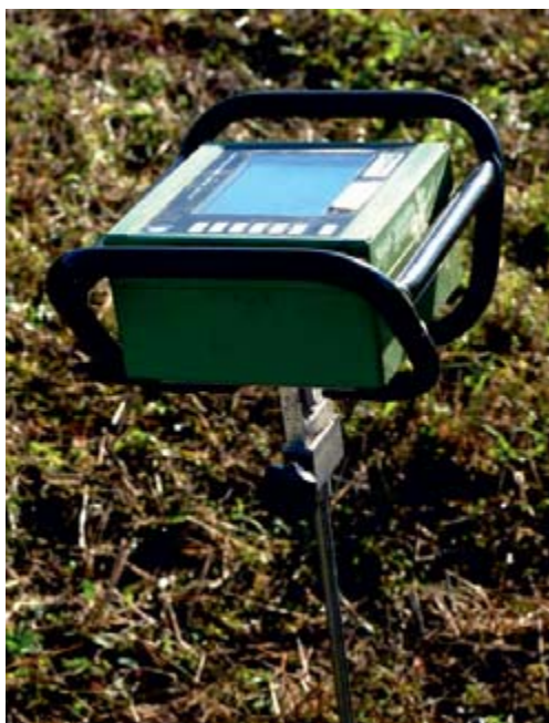
Figur 13. En konpenetrometer av märket Eijkelkamp.
