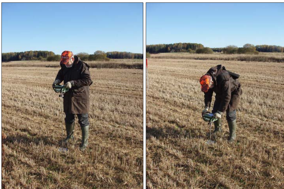
Figur 2. Mätning av konmotstånd med hjälp konpenetrometer.
