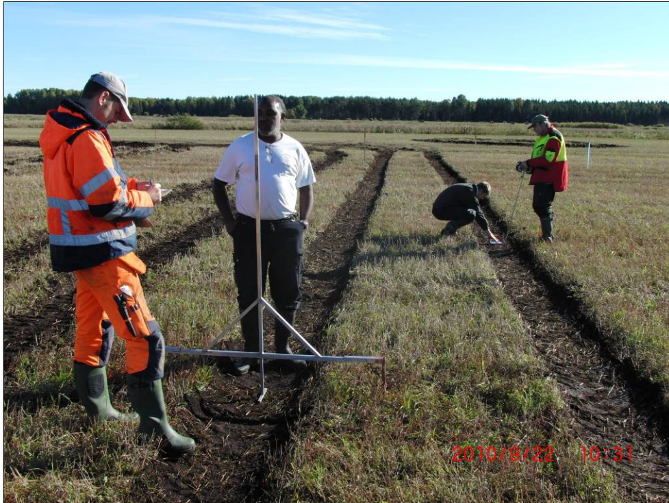
Figur 1. Mätning av spårdjup och konmotstånd.
