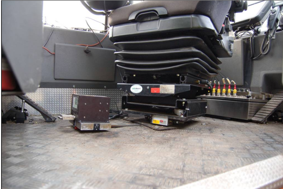
Figur 8. Mätutrustning och accelerometrar i skotaren, Lightlogg C.
