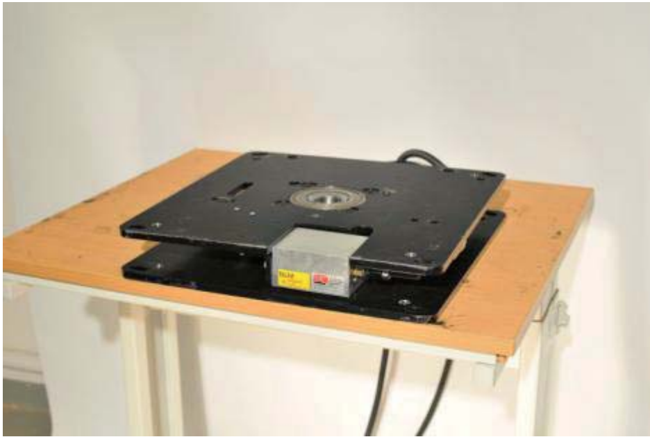
Figur 8. Kompakt vridbart underrede.
