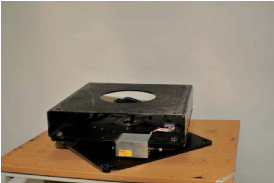
Figur 6. Kompakt vridbart underrede.
