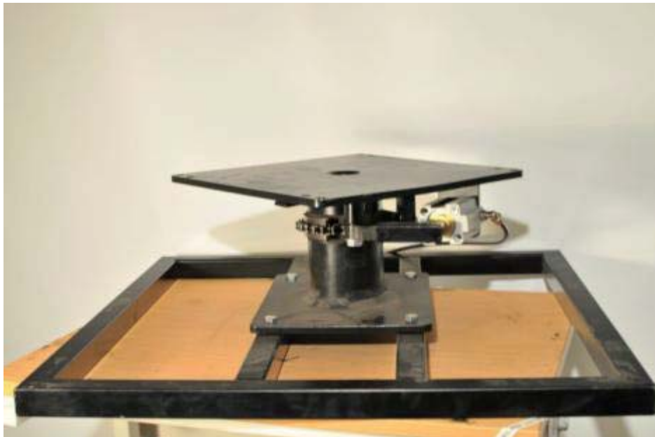
Figur 7. Kompakt vridbart underrede.
