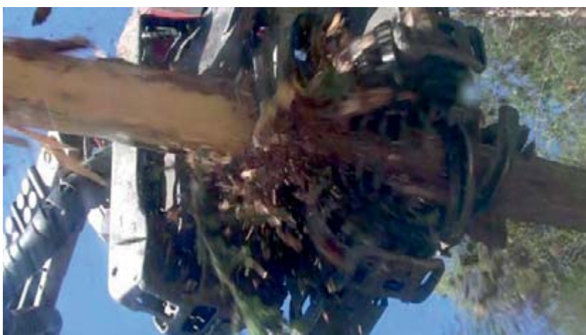
Figur 27. Bildruta från film som visar hur stora mängder bark rivs loss vid den nedre kvistkniven. Mängden flygande bark vid de övre kvistknivarna förefaller måttlig men är svår att direkt kvantifiera utifrån filmerna.
