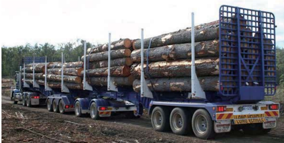
Figur 2. B-Triple från Elphinstone, ett exempel på långt fordon med ca 90 tons bruttovikt. Tasmanien, Australien.
