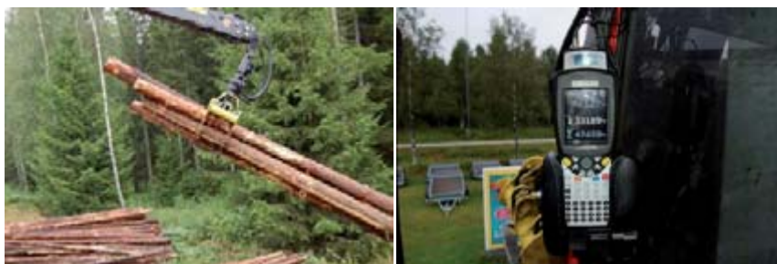
Figur 10. Intermercatos kranvåg är monterad mellan rotator och kranspets. Instrumentet för avläsning av vikten är placerad i kranhytten.
