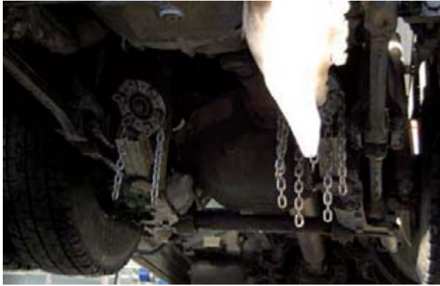
Några kättingar har lossnat på bilen.
