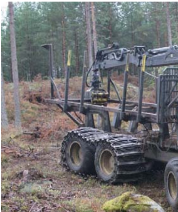
Figur 1. Skotarens lastutrymme. Notera ramverket på bankarna och förlängningen bakåt med de 2 avslutande stolparna.
