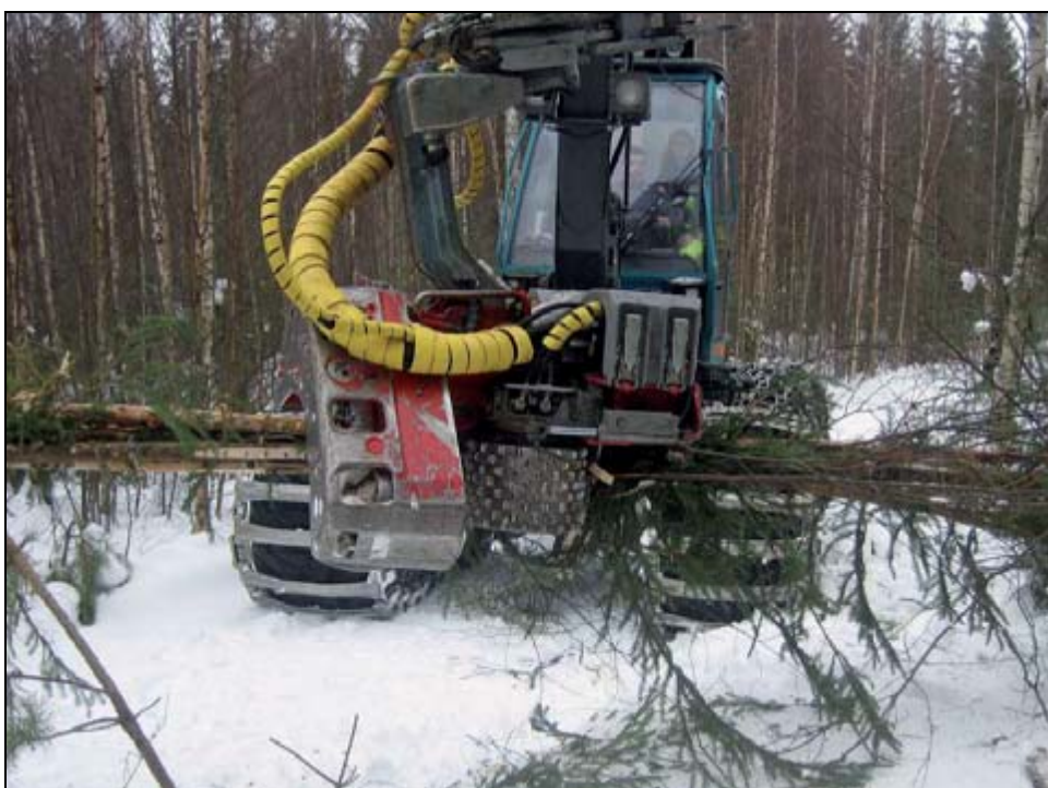
Figur 3. Log Max 4000B med ackumulerande tilläggsutrustning, monterat på en Profi-skördare, så som det kördes i försöket.
