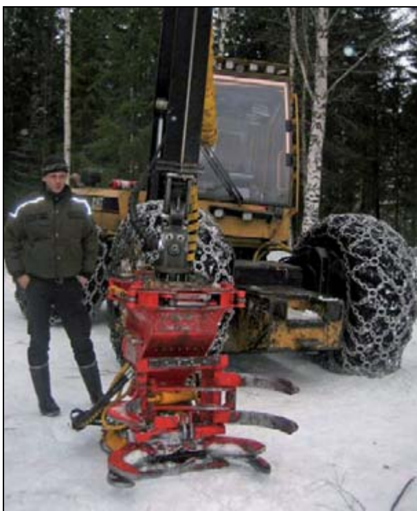
Figur 2. Naarva Gripen 1500-50E. Entreprenören har gjort vissa modifieringar av aggregatet.
