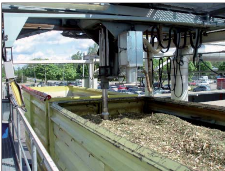
Bild 2. Automatiserat system för uttagning av fukthaltsprover vid inmätning av flis vid Eons kraftvärmeverk i Örebro.
