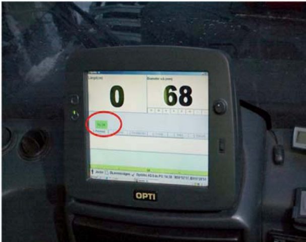
Figur 13. Ponsse skördardator inställd för grotpassning på (grön symbol). Motsvarande röd symbol indikerar grotpassning av.
