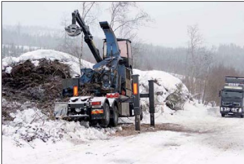
Figur 1. Hugglinken uppställd över diket i väntan på att bilen körs upp brevid linken.
