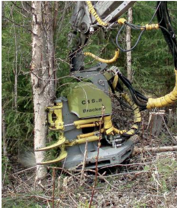
Figur 1. Bracke C16.a, ackumulerande aggregat med sågklinga.
