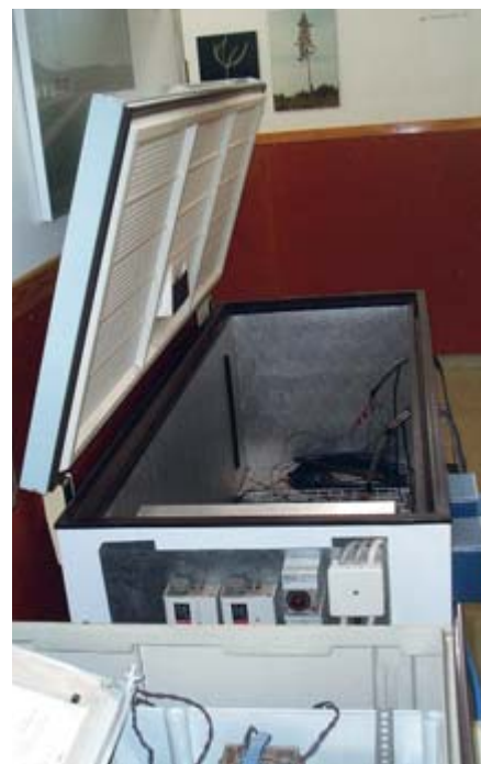
För att bestämma frystoleransen krävs en frystrustning som kan regleras och som kan nå ner till -25^{\circ}\text{C} .
