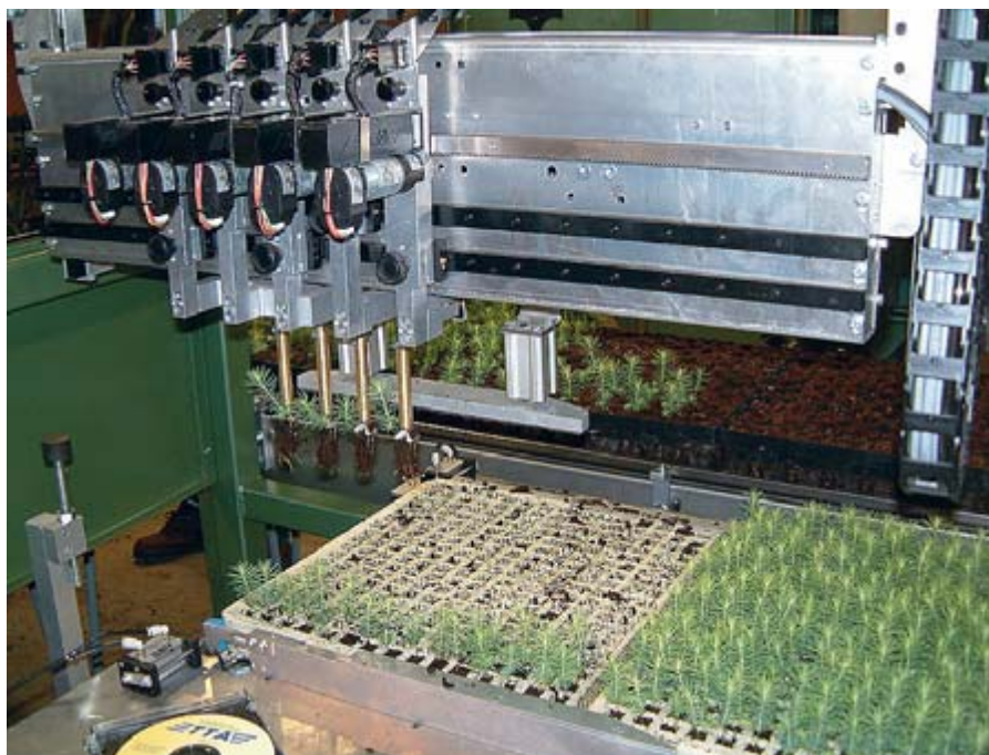
Maskinell omskolning av mikroplantor till slutbehållare i Nässja plantskola.
