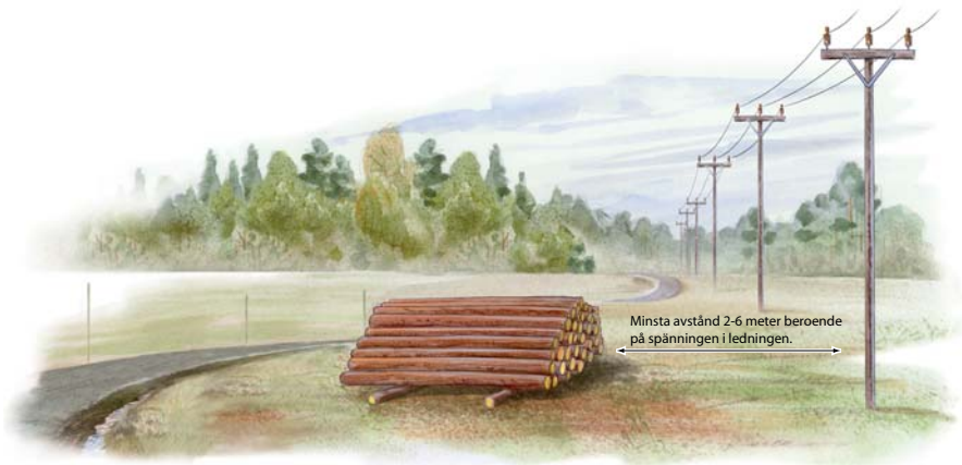
Bild som visar det horisontella avståndet mellan en trave och lodlinjen från en luftledning.
