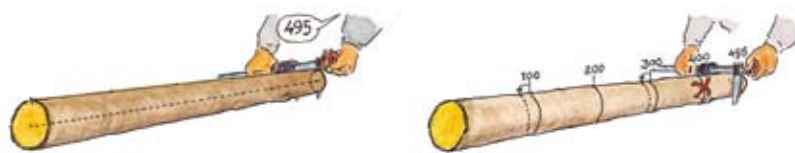
Figur 2. Mätning av längd och diameter. Normalt görs en diametermätning per meter.
