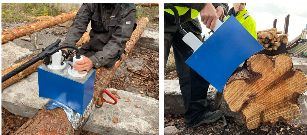
Figur 10. Foton från fälttestet av den mikrovågsbaserade barktjockleksmätaren. Foto: Monika Strömngren.
