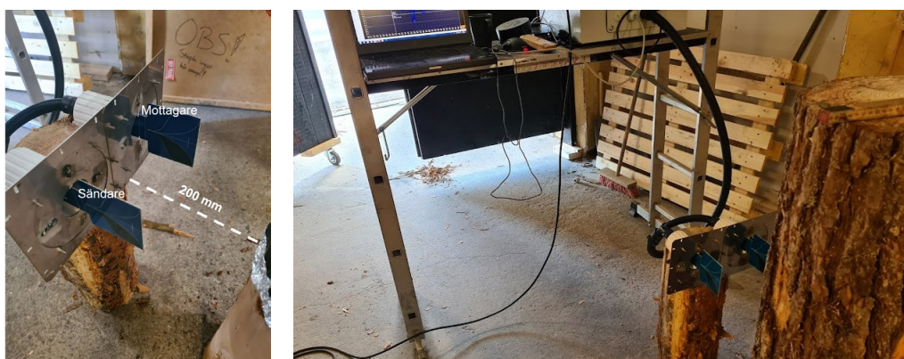
Figur 4. Mätanordning för inledande mätningar.
