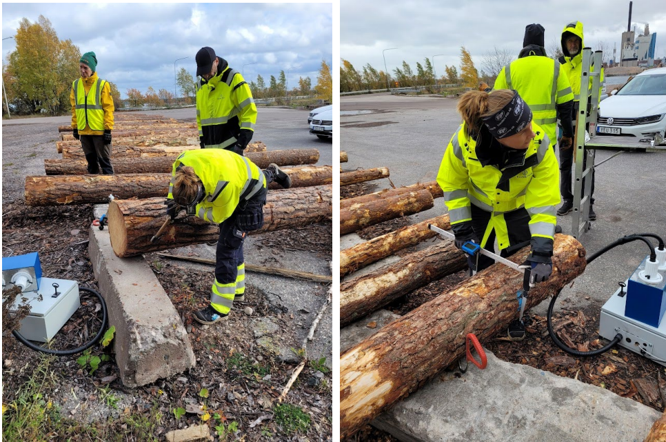
Figur 13. Avbarkning av skorpark och bastbark med yxa samt mätning med klave före och efter avbarkning.
