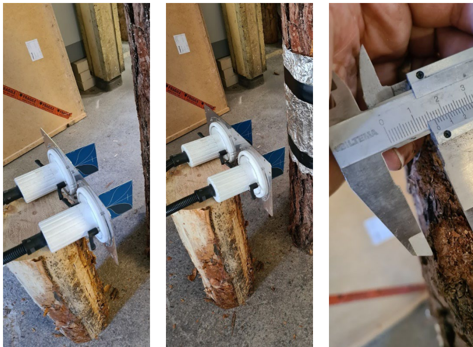
Figur 7a. Mätning mot en stock med mellantjock bark. Kontrollmätning med skjutmått.
