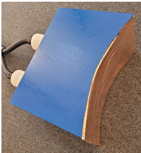
Figur 8. Design av barktjockleksmätare och tillverkad prototyp.
