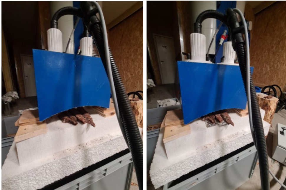
Figur 18. Mätning på bark som ligger på frigolit (frigolit är i princip osynligt för radarn), mätning på aluminiumfolie (ej bild) och mätning på bark med aluminiumfolie.
