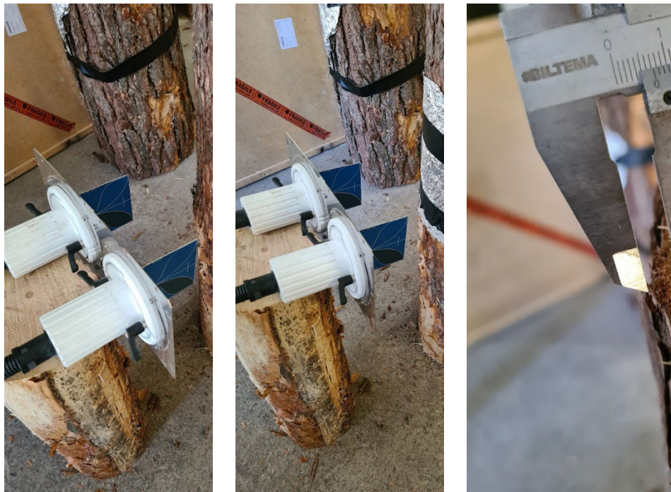
Figur 6a. Mätning mot en stock med mellantjock bark. Kontrollmätning med skjutmått.
