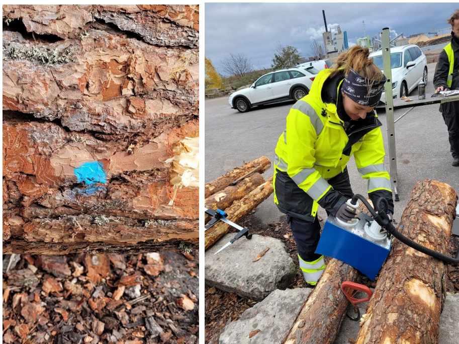
Figur 14. Märkning av mätpunkt med blå färg och mätning med radarsystem.
