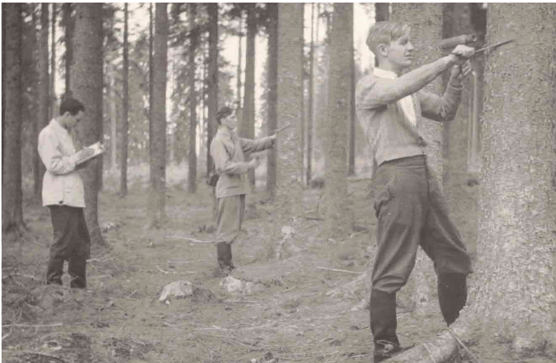
Figur 1. Klavning för volymsbestämning. Bilden är från 1950-talet vid en exkursion för lantmätare på KTH.
