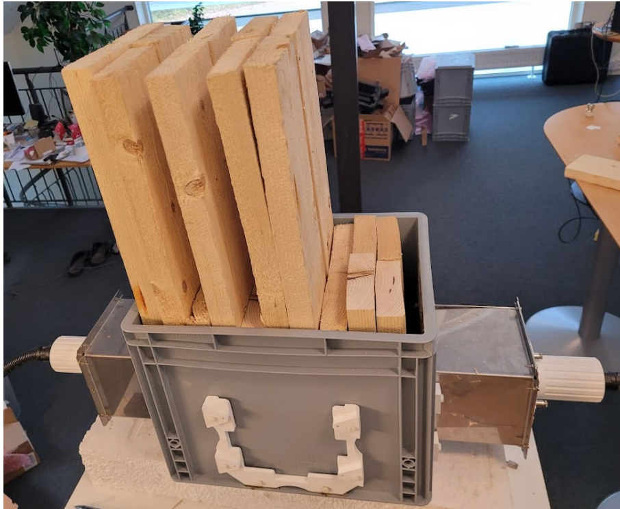
Figur 23. Mätningar olika antal lager av plankor i olika polarisationsriktningar.
