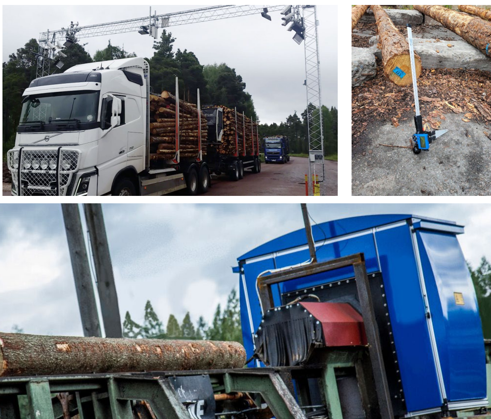
Figur 2. a) Inmätning av volym med en CIND-rigg. b) Klave för mätning av stockdiameter. c) Inmätning av timmer i mätram med en RS-LogProfiler3DX från RemaSawco.
