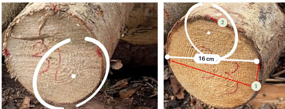
Figur 9. Närbild från diameter- och längdmätning med appen Apple Measure (Borz m.fl. 2022a). Vänster: Exempel på placering av en mätpunkt. Höger: Punkterna 1: start- och slutpunkter för diametermätning. Punkten 2: startpunkt för längdmätning.
