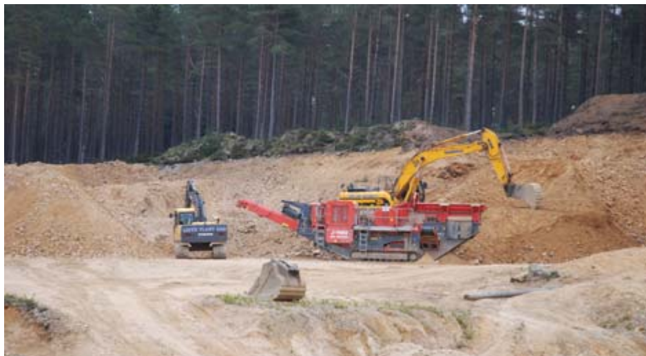
En större husbehovstakt med bandgående käftkrossverk. Foto: Per Hallgren.
