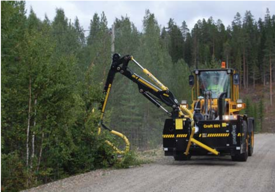
Grenar som sticker ut över vägbanan ska också röjas bort. Foto: Cranab Slagkraft.
