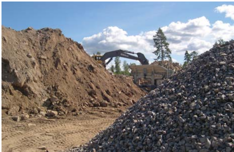
Sorterad morän till vänster och krossat bärlager till höger. Foto: Claes Löfroth.
