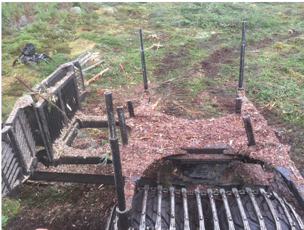
Figur 8. Drivaren X19:s lastrede med fyra skiljestöttor som möjliggör särskiljning av sortiment i tre fack. Foto: Gert Andersson
