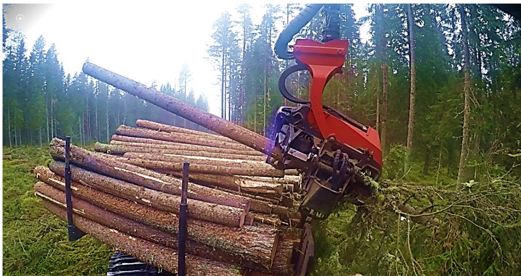
Figur 6. Upparbetning högt upp i lasset kräver att stammarna lutar. I det här fallet lutar stammen ungefär 25 grader mot marken. Foto: Hagos Lundström
