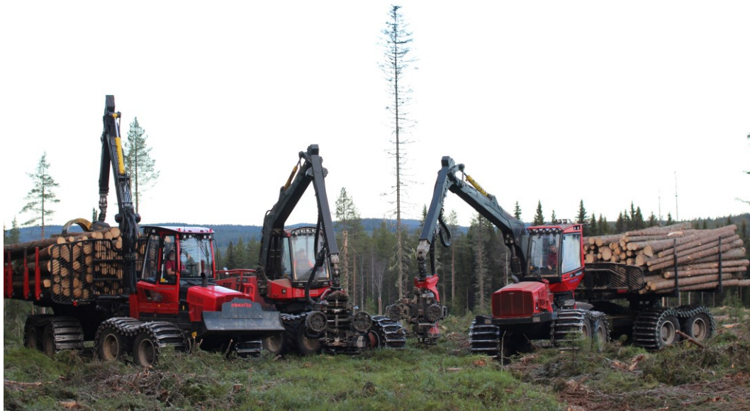
Figur 2. Ett vanligt tvåmaskinsystem med de serietillverkade maskinerna skotaren Komatsu 895 (till vänster) och skördaren Komatsu 941 (i mitten). Dessa var studieobjekt jämte enmaskinsystemet konceptdrivaren Komatsu X19 (till höger) i ett flertal av de studier som sammanfattas i denna rapport. X19 har snabbfäste och skördaraggregat för avverkningsarbete i figuren, och aggregatet byttes till skotargrip vid lossningsarbete.
