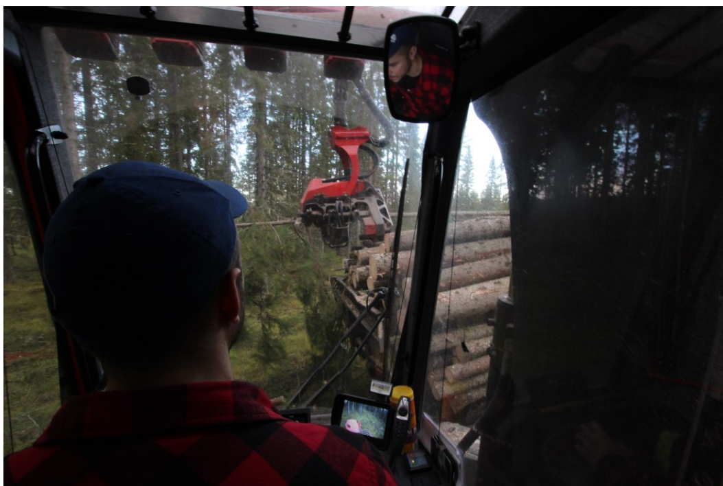
Figur 4. Förarens vy inifrån hytten på konceptdrivaren Komatsu X19, under upparbetning och direktlastning. Foto: John Sandström/BITZER
