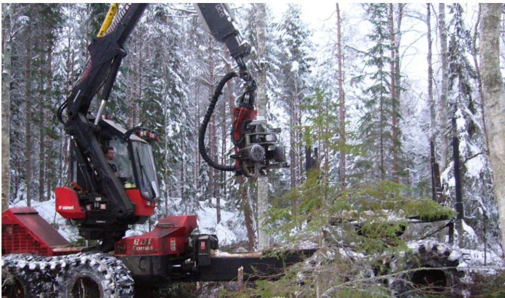
Figur 1. Den tidigare serietillverkade Valmet 801 Combi, med kombinationsaggregatet Valmet 330 DUO. Observera det stora paret skänklar i grå färg direkt ovanför matarvalsarna på aggregatet. Skänklarna möjliggjorde att aggregatet inte bara användes för avverkning, utan även lossning. Foto: Rikard Lundqvist
