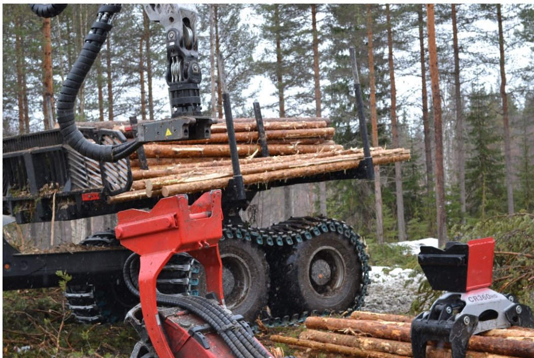
Figur 3. Det tomma snabbfästet (överst i figuren) i X19:s kranspets i samband med skifte mellan skördaraggregat (nedan till vänster) och skotargrip (nedan till höger). Foto: Rikard Lundqvist
