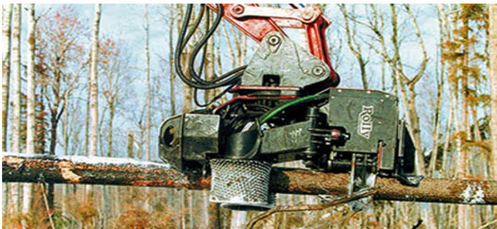
Figur 7. Risleys skördaraggregat Rolly II uppfyller flera av de krav som uppställs av det franska ECOMEF projektet. Bild från www.woodbusiness.ca/harvesting/harvesting-and-processing-heads 2016-03-24.
