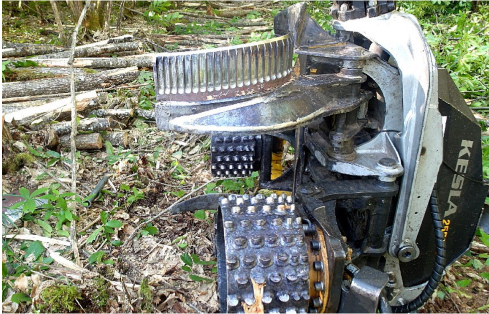
Figur 15. Med stöd från laborieförsök och FEM-modellering tillverkades kvistknivar som monterades på ett Kesla 25RH aggregat för fältförsök av de inom ECOMEF utvecklade knivarna. Detalj av foto, Dargnat m.fl., 2014.
