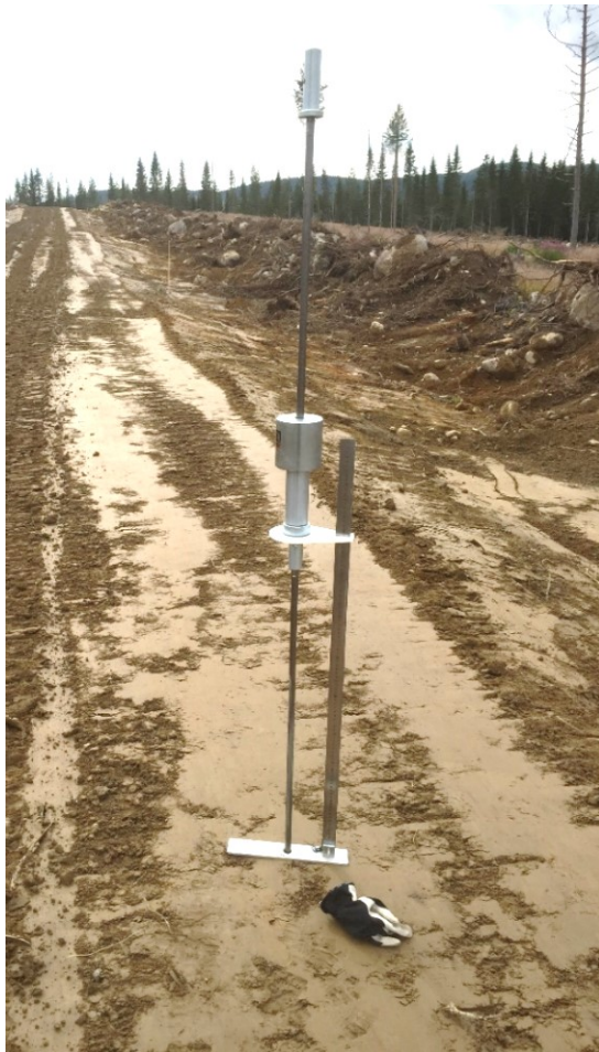
Figur 1. DCP i fält, samt ritning med DCP'ns måttuppgifter.
