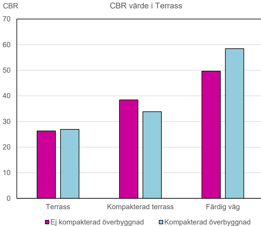
Figur 15. Medelvärde CBR per åtgärd, Terrass + kompaktering + grustransport för Sektion 1–3 finns även en extrakompaktering av överbyggnaden.
