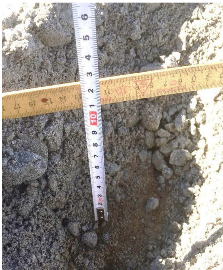
Figur 4. Mätning av grustjocklek.
