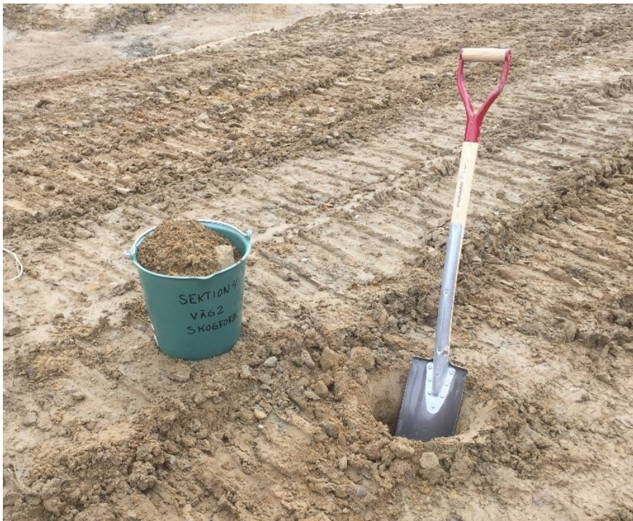
Figur 6. Insamling av materialprov från underbyggnad (Väg 2 sektion 4).
