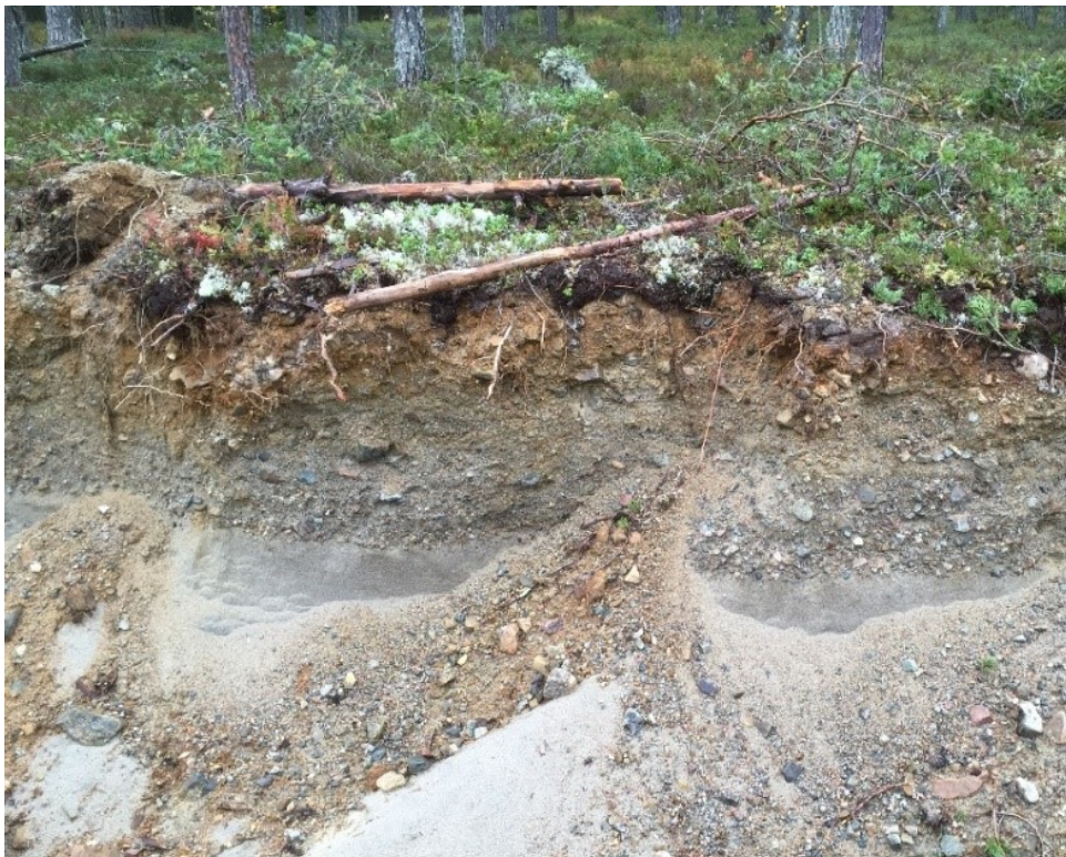
Figur 23. Stor variation av materialet undergrunden.
