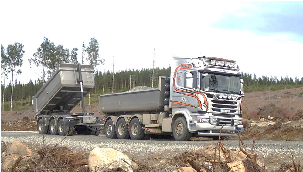
Figur 20. Påförsel av överbyggnad med CTI-utrustad grusbil.
