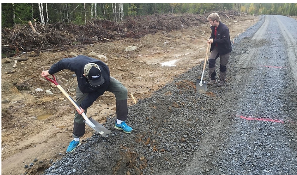
Figur 8. Mätpunkt på Väg 1 har gått till brott. Spåret skottas igen och mätning för aktuell punkt avslutas.
