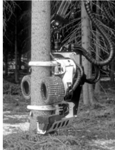
Figur 1b. Aggregat, Timberjack H762. Foto: Timberjack AB.
