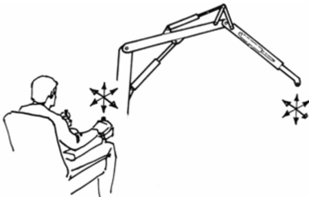
Figur 6. Kranspetsstyrning Löfgren m.fl., 1994.
